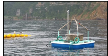
定置網にユビキタス魚探を設置することで、陸にいながら漁獲量を確認できる。
