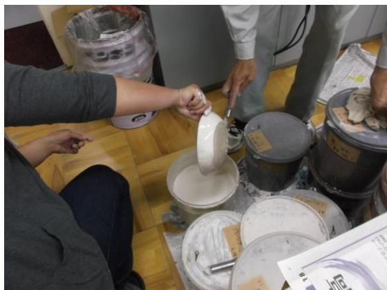
釉薬に作品を浸け、色付けを行う作業
