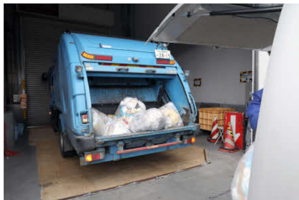
清掃センターへ搬入された燃やせるごみはパッカー車へ直接投入される
