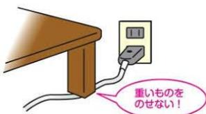
電気コードや配線が引っ張られたり、折れたり、踏まれたり、挟まれたりすることにより、配線の何割かが切断状態（半断線）になり、その部分が発熱し出火する恐れがあります。
